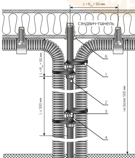
\* Минимальный применяемый опуск равен R изгиба кабельной линии.
