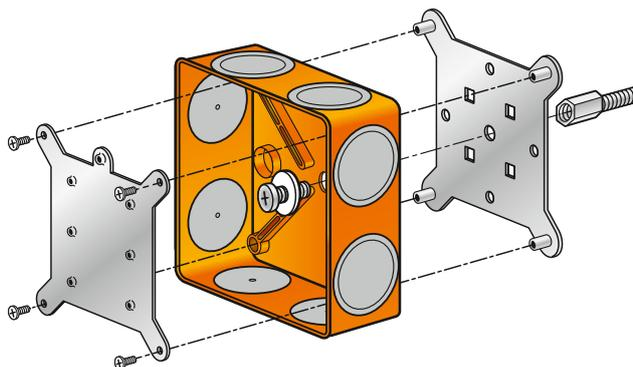
Рис. 13. Монтаж к трубным конструкциям
