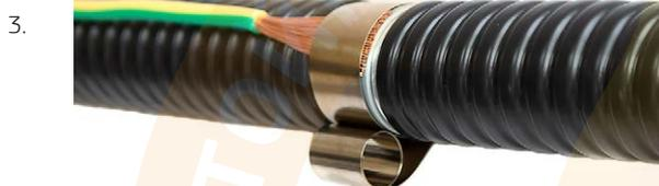
Прижать провод заземления одним витком пружины так, чтобы нижний край пружины находился на расстоянии не более 5 мм от среза изоляции.
