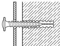
Рис. 2. Бетонные или кирпичные поверхности
