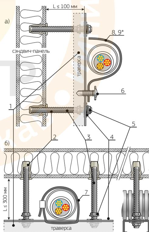
\* При использовании СМД применяется доп. саморез с прессшайбой
