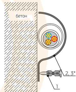
\* При использовании СМД применяется доп. гвоздь по бетону
