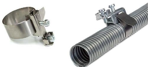
При отсутствии возможности установки заземляющего устройства на вводную муфту ВМ или ВМУ, заземление металлорукава выполняется с помощью хомута заземления Промрукав. Это устройство заземления возможно установить в любом наиболее удобном месте. Хомут устанавливается на металлорукаве и с помощью винтового зажима, зажимается на нем.
